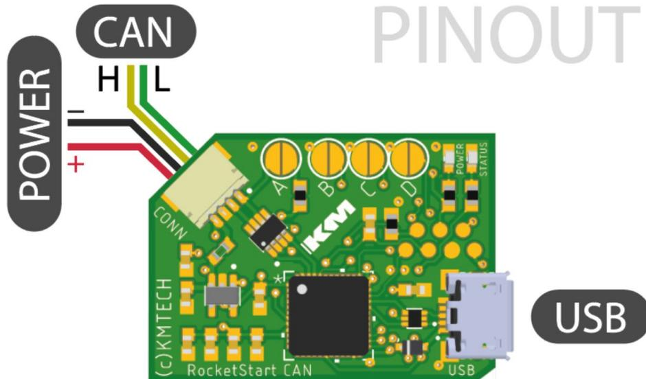
**Tension d'alimentation** : entre 4V et 17V. Protégé contre les inversions de polarité.
